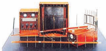
八木・宇田アンテナを初めて実用化した極超短波無線送受信機
